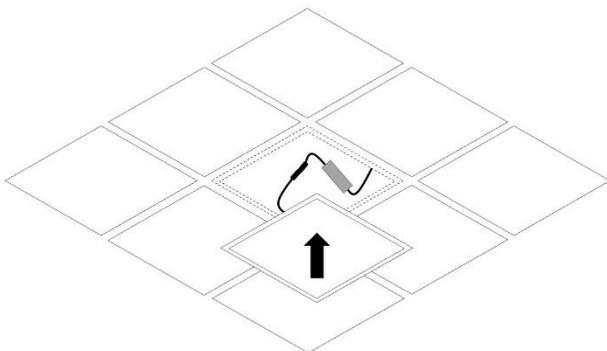
Anschließend legen Sie das LED-Einlegepanel in die Halterung der Decke, Aufbaurahmen oder Einbaurahmen.
